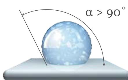
На поверхностях мойок с защитой Florentina<sup>©</sup> угол смачивания более  $90^\circ$ . Поэтому капли воды не растекаются, обеспечивая низкую степень увлажнения и загрязнения
