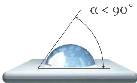
При соприкосновении с поверхностью мойки без гидрофобизирующей защиты угол смачивания составляет менее  $90^\circ$ . Капли воды рас текают ся, увлажняя всю поверхность
